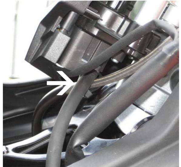
**Armaturenkabel:** Beide Armaturenkabel an der Verzweigung abisolieren und das nach unten führende Bougierrohr um ca. 2cm kürzen. Die Verzweigung der Kabel auseinanderspreizen und mit Isolierband neu abdichten.
